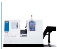
TM 6 Струг разстояние между центрите: 400 мм обработв. диаметър: 250 мм патронник ø: 150 мм
