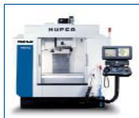
VMX 42 t ХОДОВЕ: 1060 x 610 x 610 мм СКОРОСТ НА ШПИДЕЛА: 12.000 об./мин.
