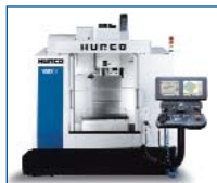
VMX 1 ХОДОВЕ: 660 x 355 x 455 мм СКОРОСТ НА ШПИДЕЛА: 10.000 об./мин.
