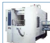
HTX 500 (хоризонтален обработващ център) с автоматична смяна на палетите ХОДОВЕ: 710 x 610 x 610 мм 2 палета 500x500 мм СКОРОСТ НА ШПИДЕЛА: 12.000 об./мин.
